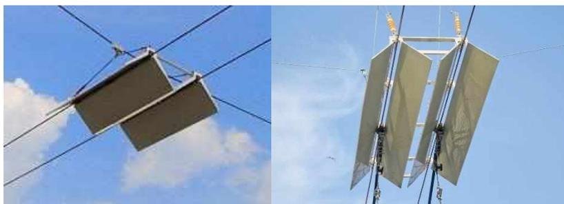
*Рис. 1.* Кондуктор штанговых токоприемников
