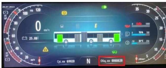
*Рис. 2.* Общий вид приборной панели автобуса VOLGABUS 627102 на конец подконтрольных испытаний
