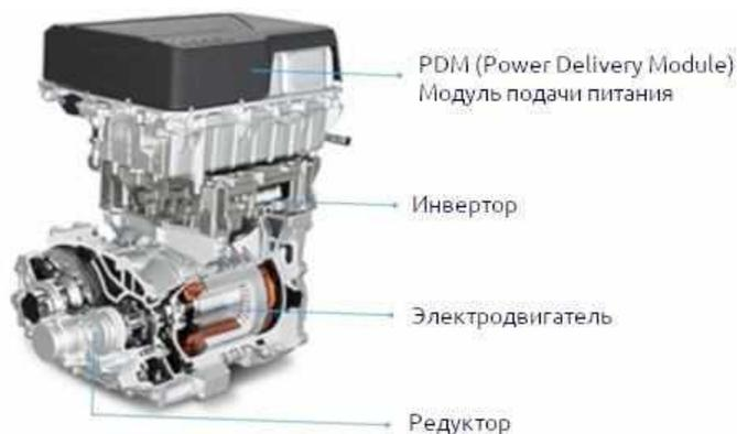
Рис. 2. Компоновка элементов электрической движущей части
