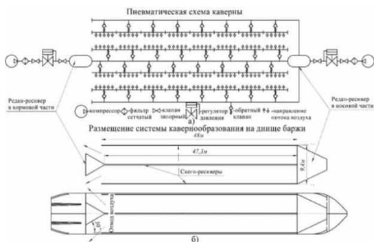
Рис. 7. Схематичное отображение реализации системы по созданию воздушной каверны для баржи проекта 775:
