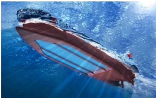
*Рис. 1.* Внешний вид судна с каверной
